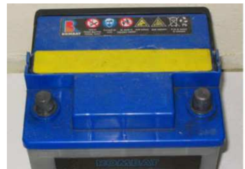
Batterie au plomb
