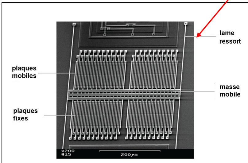
**3- Principe de la mesure sur un axe**
