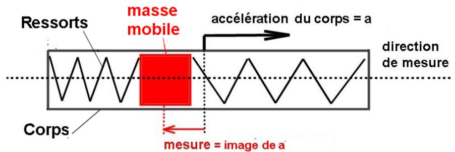
Fonction pour laquelle l'accéléromètre a été conçu : **mesurer l'accélération selon la direction de mesure.**
