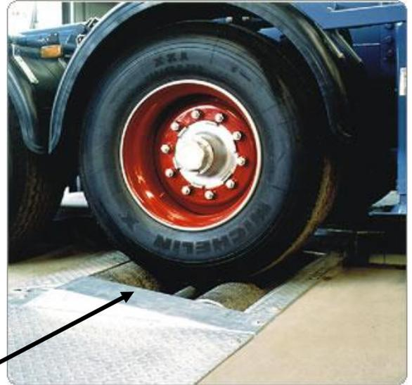
Rouleaux entraînés par les roues du véhicule
