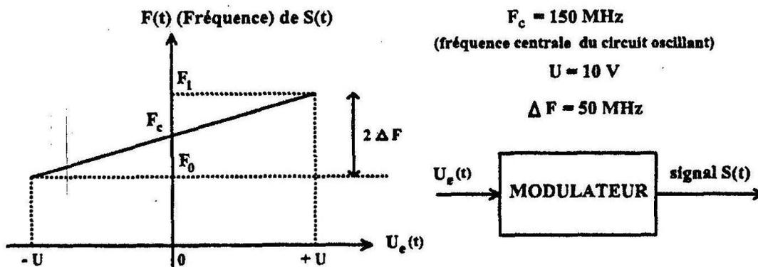
Le signal  $n(t)$  est appliqué à l'entrée du modulateur, soit  $U_e(t) = n(t)$ .
