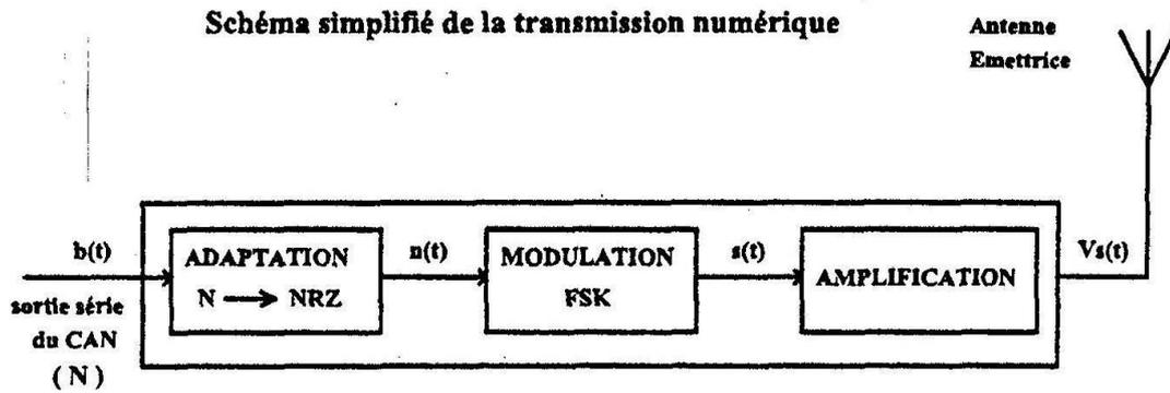
La sortie série  $b(t)$  issue du CAN doit être adaptée en signal NRZ (Non Retour à Zéro)  $n(t)$  qui à son tour subit une codification en fréquence FSK et est transmis après amplification à une antenne émettrice.
